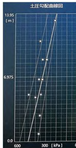
チャンバー内圧力勾配のリアルタイム監視状況
