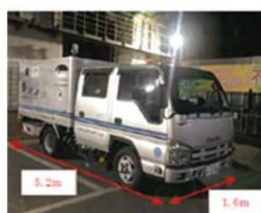
路面下空洞探査車
