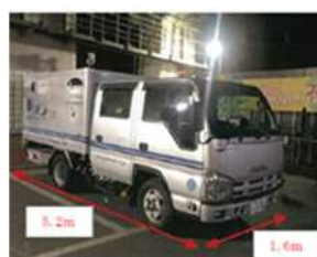
路面下空洞探査車
