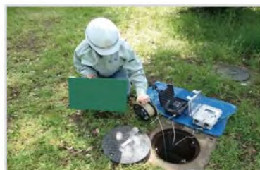
地下水位の観測状況
