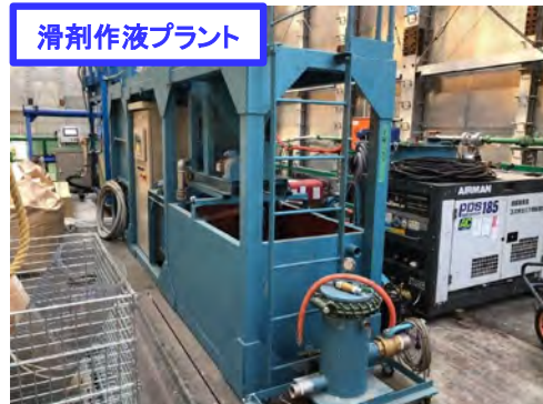
滑剤充填設備(東名JCT Hランプシールドトンネル工事の状況)
