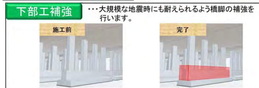
耐震補強工施工イメージ
