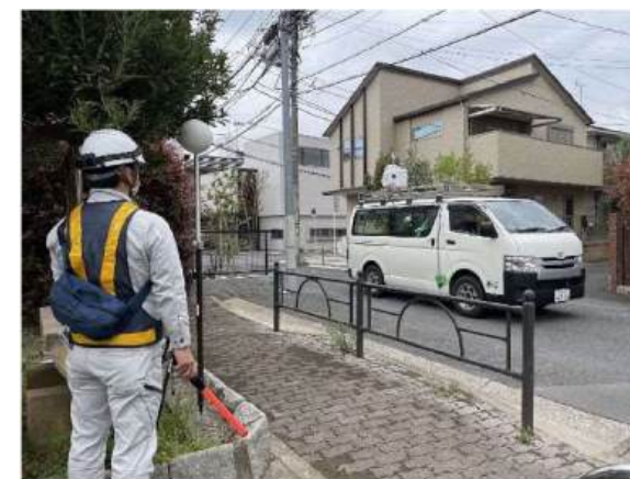
MMS[3D点群調査](車道部)
