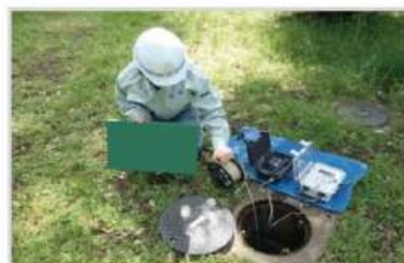
地下水位の観測状況
