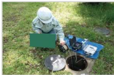
地下水位の観測状況
