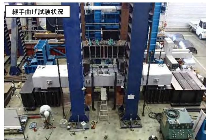
スタッドジベル : 鋼材とコンクリートを一体化させる金属の部品
