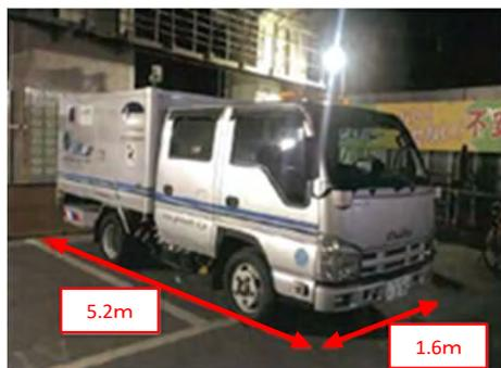
路面下空洞探査車(車載式レーダー)
