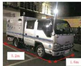
路面下空洞探査車
