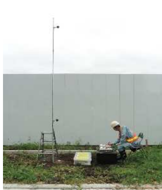
騒音、振動測定状況
