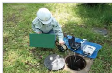
地下水位の観測状況
