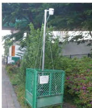
大気質（粉じん等）測定状況
