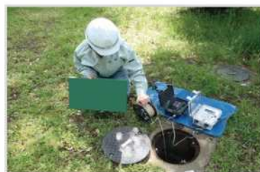
地下水位の観測状況
