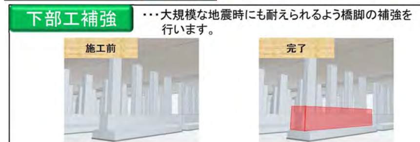
耐震補強工施工イメージ
