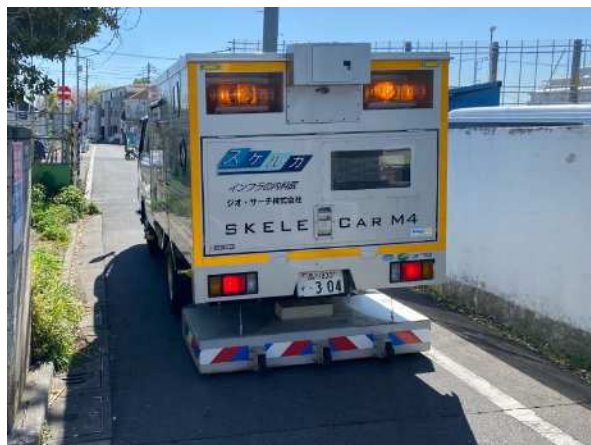
路面下空洞調査(車道部)
