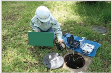
地下水位の観測状況
