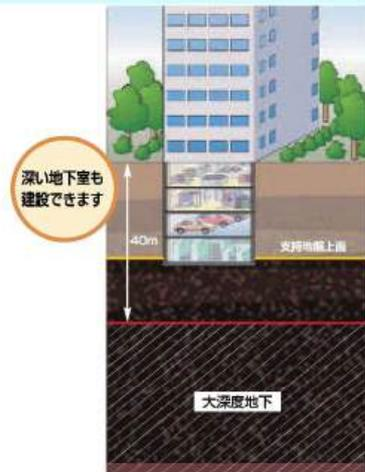
②建築物の基礎の設置のための利用が通常行われない深さ（支持地盤上面から10m以深）
