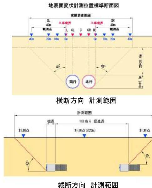
地表面変状は掘進前後の最大地表面傾斜角(1,000分の1rad以下)により管理する。
