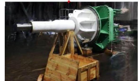
破断したモーター駆動軸部 概要図
