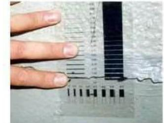
例: 亀裂損傷調査
