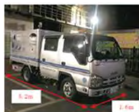
路面下空洞探査車
