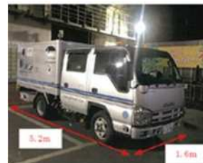
路面下空洞探査車
