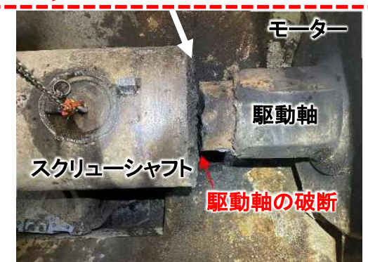
駆動軸の破断状況
