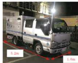
路面下空洞探査車
