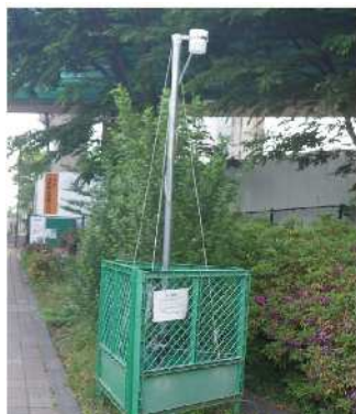
大気質(粉じん等)測定状況
