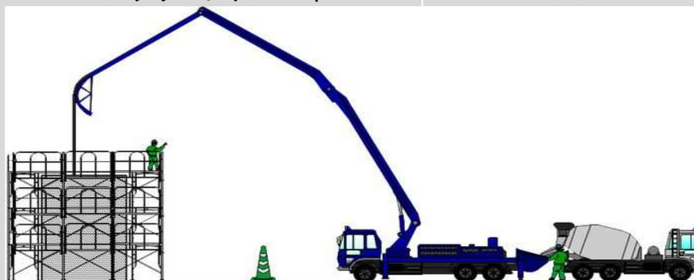
コンクリートを圧送する機械
