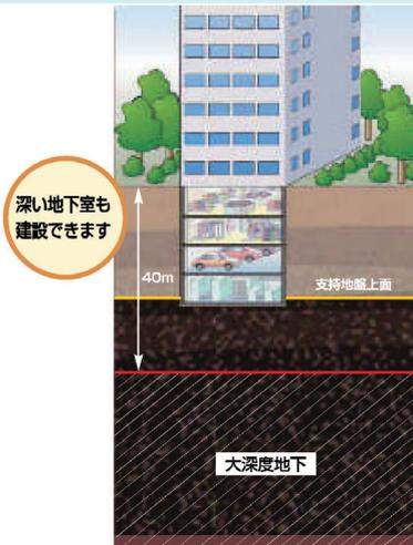
②建築物の基礎の設置のための利用が通常行われない深さ(支持地盤上面から10m以深)
