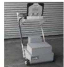
路面下空洞調査 （ハンディ型地中レーダー）
