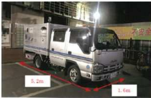
路面下空洞探査車（車載型レーダ）
